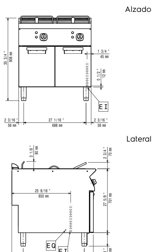
EI = Conexión eléctrica (energía)
